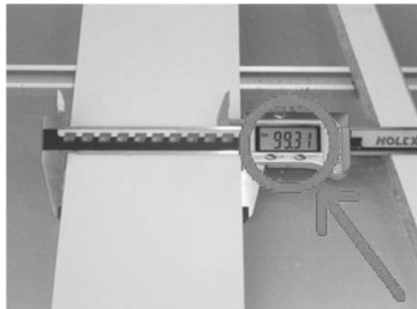
Отпишите деревянный брусок и измерьте его. Например: 99,31 мм.
